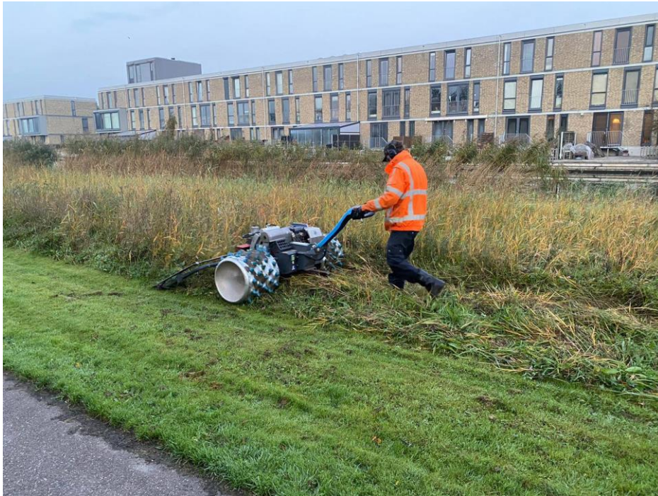
RVR heeft een speciale maaimachine ingezet om riet in de Overbos orchideeën weide te maaien en te hooien, die de bodem niet kapot rijdt en verdicht
